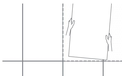
製品の位置を決めた後に、両面テープ・接着剤の位置を手で押さえ込むようにして製品全面を十分に圧着させてください。
